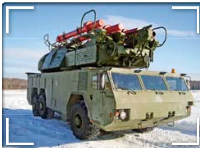
Корпусное шасси МЗКТ-69221 под вооружение ЗРК «Бук-М2Э» MZKT-69221 chassis employed in the Buk-M2E SAM system
